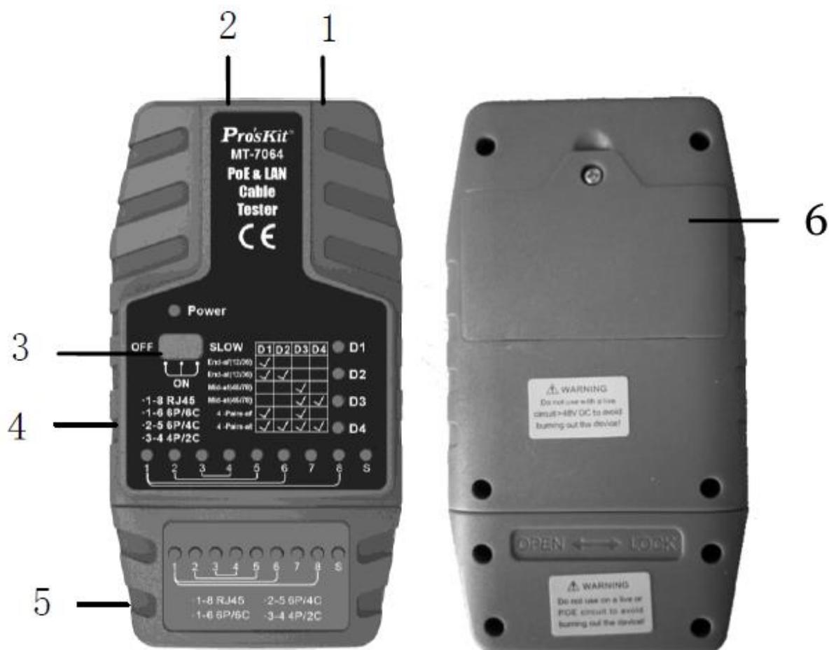
1. Разъем для тестирования схемы разводки кабеля RJ45
