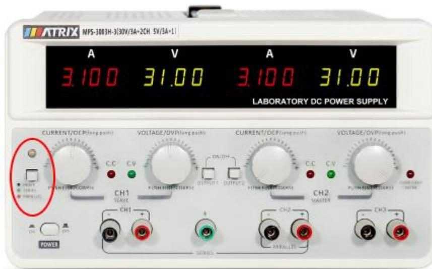
Для включения **последовательного** режима, кратковременно нажмите кнопку переключения режимов. Индикатор над кнопкой переключения режимов подсветится зелёным светом. При этом на дисплее прибора слева отобразится символ **последовательного** режима **SE**, а справа – выходные параметры. Выход источника в данном режиме снимается с отрицательного терминала 1-го канала **CH1** и положительного терминала 2-го канала **CH2**. Включение и выключение выхода производится кнопкой **CH2**.
